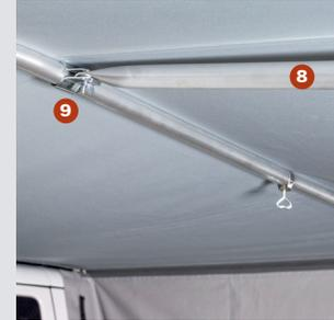
Wenn dir das immer noch nicht genug Stabilität ist, gibt es als weiteres optionales Zubehör eine Stange **8**, die zwischen der gebogenen Querstrebe und der vorderen Mittelstrebe mit Klemmen **9** verbunden werden kann. Auch diese Stange ist teleskopierbar und mit einer Schraube auf der passenden Länge zu fixieren.
