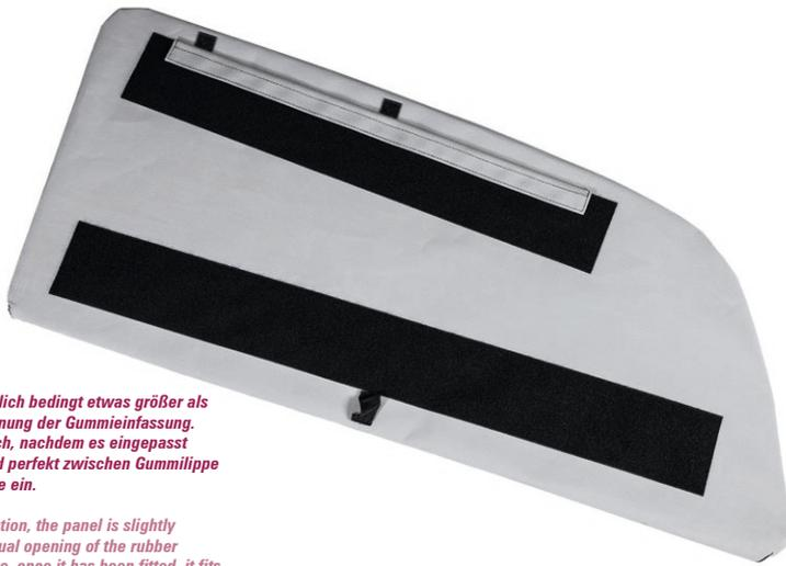
**Das Paneel ist baulich bedingt etwas größer als die eigentliche Öffnung der Gummieinfassung. Deshalb fügt es sich, nachdem es eingepasst wurde, nahtlos und perfekt zwischen Gummilippe und Fensterscheibe ein.**
