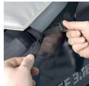
Zusätzlich sind an der Frontscheibenisolierung Schlaufen für eine weitere Abspannungen an den Felgen vorhanden. Führe den Gummieriemen durch die Schlaufe und einer Öffnung der Felge und schließe den Klickverschluss. Auch hier kannst du den Gurt nachjustieren und so straff wie erforderlich spannen. Gleiches jetzt auf der anderen Fahrzeugseite.
